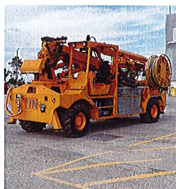
Robot Projecção de Betão
